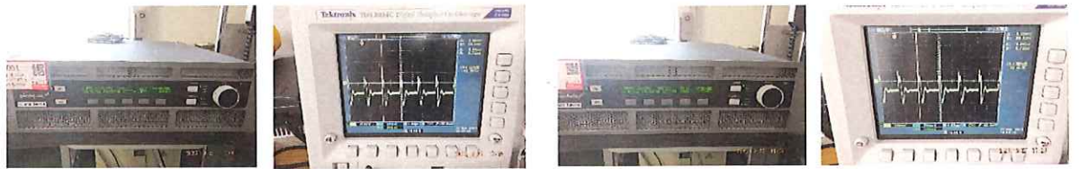
取扱説明書(無) A ch 5012w出力 150.3 KHz表示 B ch 5008w出力 150.4 KHz表示
