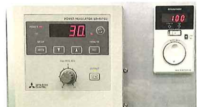
左:テンションコントローラー 30%設定 右:モーターコントローラー 100r/min設定
