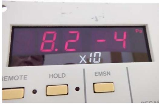
NORMAL点灯時の到達圧力:  $8.2 \times 10^{-4}$  Pa
