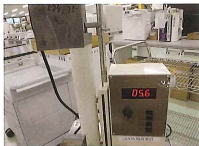
点検用錘測定(574.75g):表示値5.6 ※点検結果表参照
