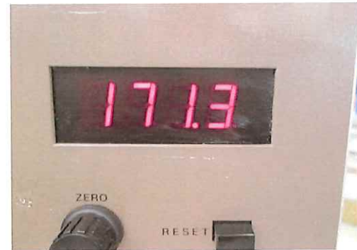
試料171.3Nで破断確認
