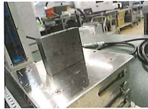
ゲージブロック30mmを測定
