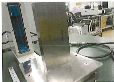
ゲージブロック75mmを測定
