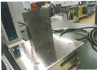
ゲージブロック50mmを測定
