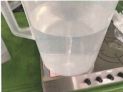
4ヶ所水3L攪拌確認。
