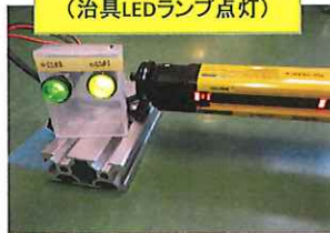
障害物検知 セフティー回路:ON (治具LEDランプ点灯)
