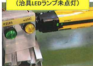
障害物無し セフティー回路: OFF (治具LEDランプ未点灯)
