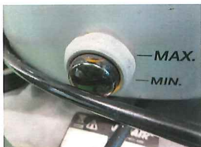
オイルレベル確認
