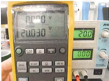
DC電源にて20V出力を測定 20.030V
