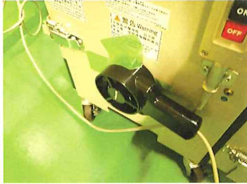
吸気口風速測定
