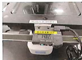
X軸→カウンタ表示はするが動作不良
