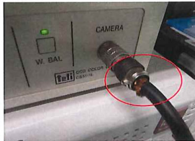
イモネジを締め付け過ぎると 接触不良発生
