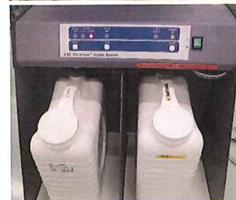
FACS Flow液タンク・廃液タンク
