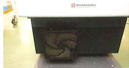
空冷ファンフィルター劣化(前面)
