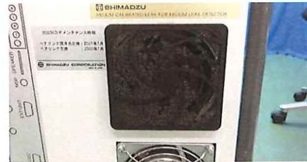
空冷ファンフィルター劣化(後面)
