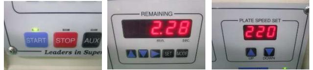
社内測定器(Model460)を使用し実回転数 測定
