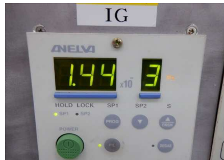
(社内検査用)M-430HG表示圧力 : 1.44 \times 10^{-3} \text{Pa}
