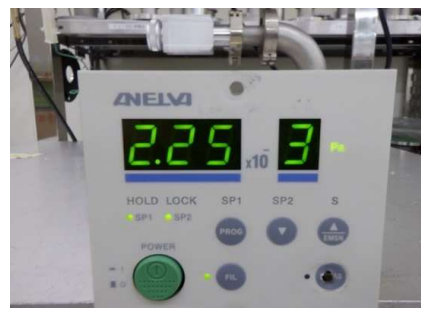
(NC0973) M-431HG 表示圧力 :: 2.25 \times 10^{-3} \text{Pa}
