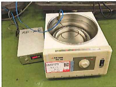
槽内に熱電対
