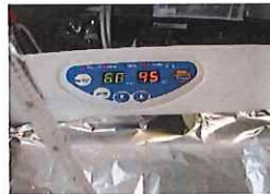
昇温時間確認 (機器表示45°C よりアルミホイルにて蓋)
