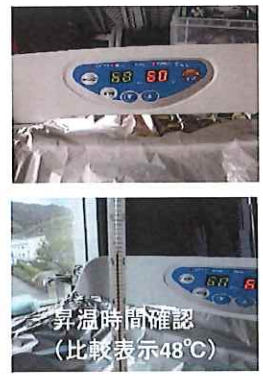
昇温時間確認 (機器表示45°C よりアルミホイルにて蓋)
