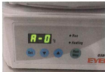
上限温度アラーム発生時(点滅)
