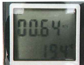
吹出風速測定
