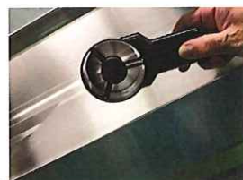
150x1780開口部で風速測定
