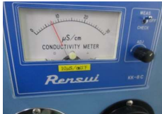
伝導率計 日本錬水製KK-8C : 7.5μS/cm
