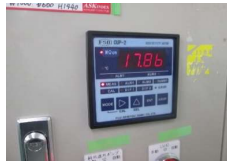
比抵抗計 藤精密電気製CUP-2 : 17.86MΩcm
