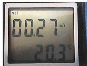
吹出風速測定
