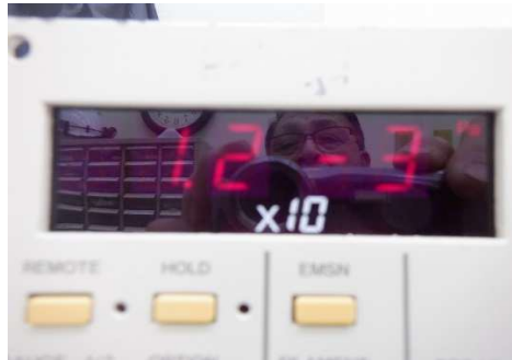
NORMAL点灯時の到達圧力: 1.2 \times 10^{-3} Pa
