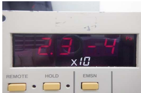
NORMAL点灯時の到達圧力: 2.3 \times 10^{-4} Pa
