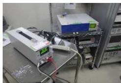
※出力測定 PLZ664WA (電子負荷装置使用) Max750W
