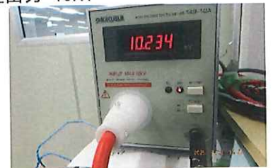
高電圧計表示 10.234 KV
