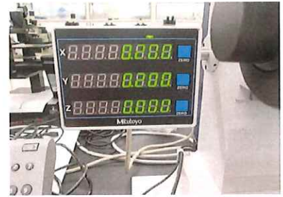
標準試料(透過X方向、Y方向)計測 結果X:0.200mm Y:0.200mm
