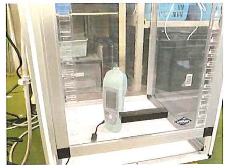
ベンチ内でパーティクル測定 吸引流量2.83L/min
