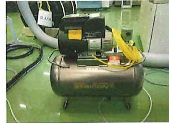
コンプレッサー
