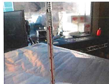
温度比較(赤液棒状温度計：52℃)
