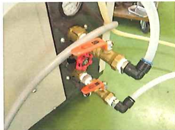
IN,OUTバルブ閉、バイパスバルブ開。
