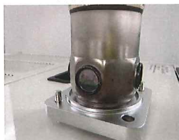
X線管劣化(窓4箇所クモリ)
