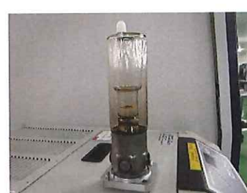
X線管外観(劣化)
