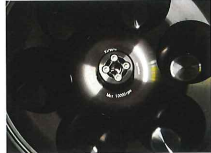
ローターA-5006、回転数MAX10000rpm
