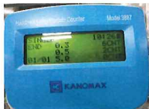
実機測定結果 0.3 \mu m:6個 0.5 \mu m:2個 5.0 \mu m:0個
