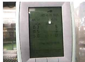
比較器機測定結果 0.3 \mu m:5個 0.5 \mu m:3個 5.0 \mu m:0個
