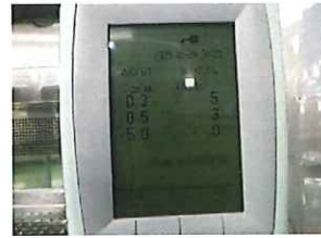
比較器機測定結果 0.3 \mu\text{m} :5個 0.5 \mu\text{m} :3個 5.0 \mu\text{m} :0個
