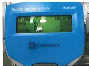
実機測定結果 0.3 \mu\text{m} :3個 0.5 \mu\text{m} :0個 5.0 \mu\text{m} :0個
