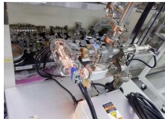
測定ゲージはアネルバ製 BRG-1B(社内検査用)
